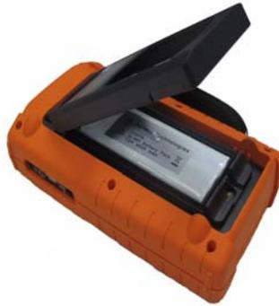
**Figure 8-5** Dépose du couvercle du compartiment de la batterie sans démontage de la béquille
