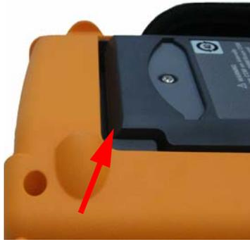
**Figure 8-1** Pression à exercer dans le sens de la flèche pour le démontage de la béquille
