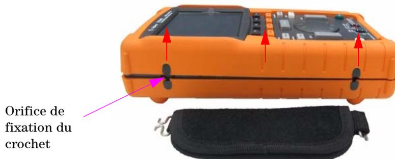
**Figure 8-8** Démontage de la poignée de l'instrument
