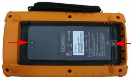
**Figure 8-3** Dépose des vis du couvercle du compartiment de la batterie
