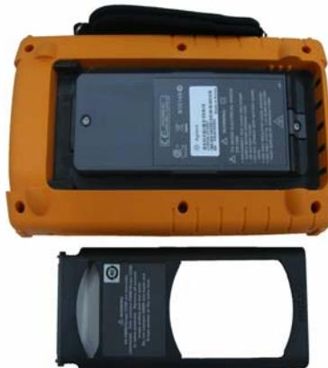
**Figure 8-2** Démontage de la béquille de l'instrument
