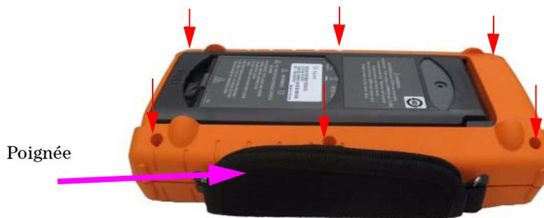
**Figure 8-7** Dépose des vis du capot arrière
